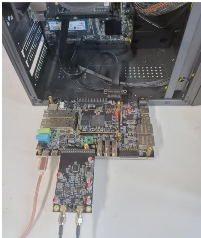
图 1-14 硬件连接图（延长线接法）
