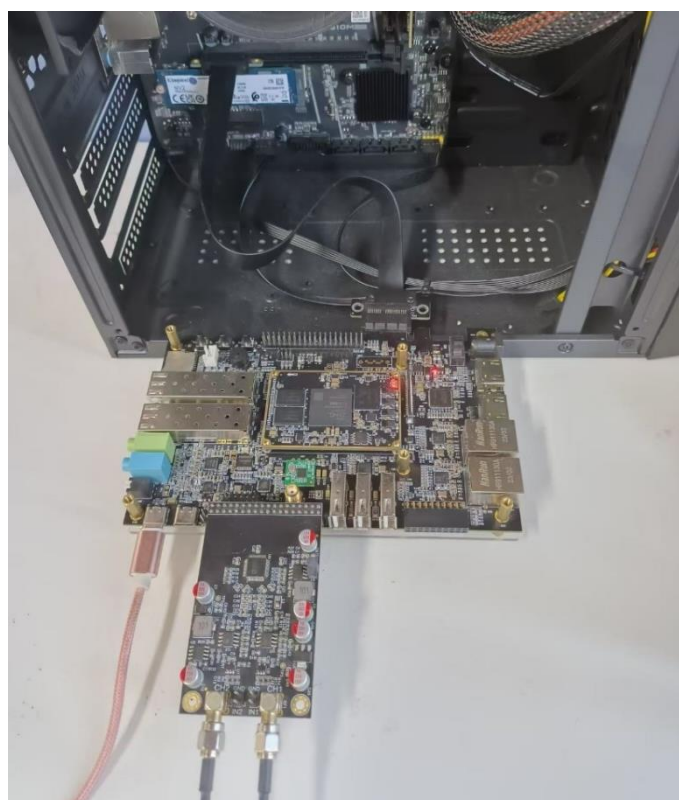
图 1-14 硬件连接图（延长线接法）
