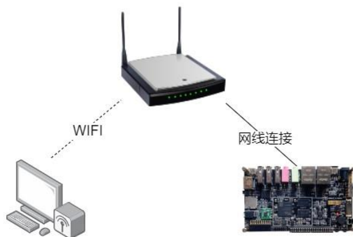
图 1-1 硬件连接框架图
