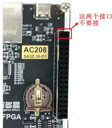
图 1-23 TFT LCD 屏连接时需要空出的引脚
