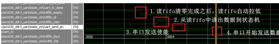
图 1.18 清读 FIFO 完成到串口发送数据开始工作仿真波形
