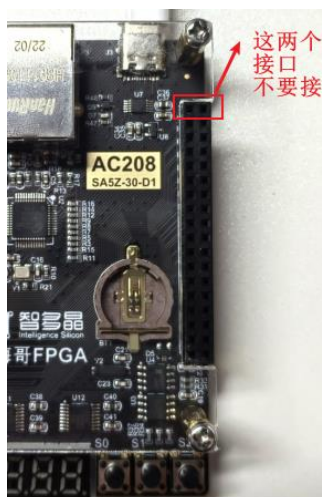
图 7.5 TFT LCD 屏连接时需要空出的引脚
