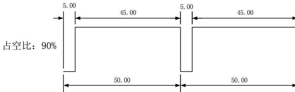
由图可知，当信号周期一定，信号高电平时间所占总时间的百分比不一样，即为不同占空比的 PWM 波。在逆变电路中，当使用这样的波形去驱动 MOS 管的导通时，因为一个周期内不同占空比的 PWM 信号其高电平持续长度不一样，因此使得 MOS 管的开通时间也不一样，从而使得电路中的平均电流也不一样，因此，通过调整驱动信号的占空比即可调整被控制电路中的平均电流。
