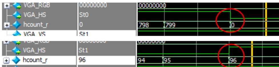
由图可见，VGA\_HS 在 0~95 这一行扫描段内为低电平，即行同步头，其他时间为高电平，行扫描一次，行扫描计数器计数最大值为 799，即刚好 800 个像素时钟周期，与设计一致，因此可知行扫描信号满足时序设计要求。
