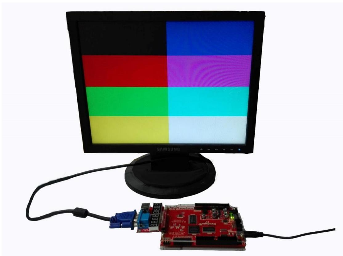
通过照片可知，VGA 控制器设计能够稳定正确的刷新 VGA 显示器并控制正确的显示位置，因此设计无误。
