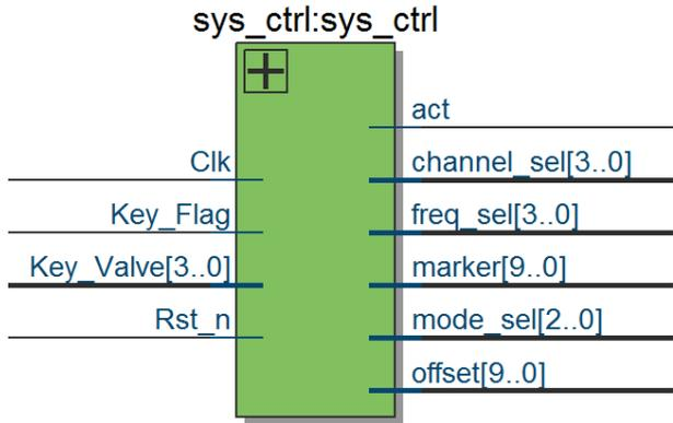
至此，整个逻辑分析仪的关键部件设计就完成了，只需要将所有的模块按照预先设置好的架构连接起来，就能构成完整的系统了。本设计的精妙之处就在于对于功能模块的合理划分，通过将数据处理部分，显示部分，控制部分分开设计，并留出方便易用的接口，因此在最后组合系统时，不需要再进行任何的接口转换逻辑就能直接连接成为一个完整的系统，这也是笔者一直坚持的数字系统设计思想，即合理划分模块，通过让系统中的每一个模块既能独立设计验证，能够方便的与其他模块交互，实现灵活多变的应用，例如，本例中红外遥控、PS2 键盘、VGA 驱动、PWM 波模块等都可以直接提取出来作为一个独立的驱动用于其他设计中。希望读者仔细体会这种模块化设计的优势。
