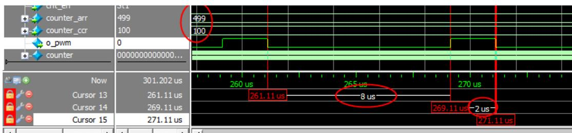
由此可知, 该 PWM 生成电路能够正确的产生 PWM 输出信号。
