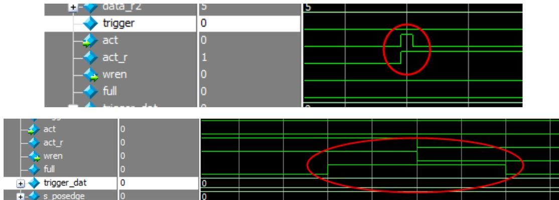
以下为使用 SPI\_NCS 下降沿信号触发采样的 RAM 写请求和写地址的信号变化波形，从波形可知，采样模块能够在 SPI\_NCS 的下降沿时启动写 RAM，并开始控制地址增加，直到最后 RAM 写满后，才停止写 RAM。即整个模块设计正确无误。
