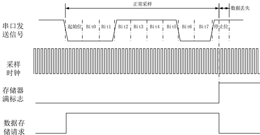
因此，为了保证采样结果的完整性，我们可以适当降低采样速率，例如，当我们将采样时钟从 1MHz 降低为 100KHz 后，从开始采样到最终存储器被存储满，就可以采样 10.24ms，远远大于串口一个字节的传输长度，因此就能保证完整的数据采集。而使用 100KHz 的采样时钟，每两个采样点间的间隔为 10us，而 9600 波特率下，串口传输一个数据位的时间为 104us 左右，即能够保证串口的每一位都能被采样 10 次，这对于分析串口传输波形来说，已经足够了，而之前使用 1MHz 的采样时钟，串口每一位被采样 100 次，这么高的采样密度对于分析一位数据来说，并没有任何实质性的效果提升。因此，合理选择采样率，能够在保证数据完整性的同时，降低对存储器容量的要求。本节，我们就设计一个采样时钟控制模块，通过控制该模块产生不同频率的采样使能时钟信号，实现控制逻辑分析仪数据采样速率的功能。
