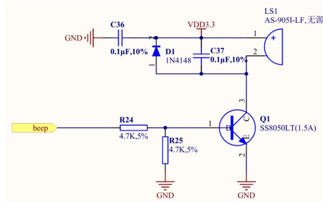
电容 C37 用于提高电路抗干扰性能。D1 起保护三极管的作用，当三极管突然截止时，无源蜂鸣器两端产生的瞬时感应电动势可以通过 D3 迅速释放掉，避免叠加到三极管集电极上从而击穿三极管。
