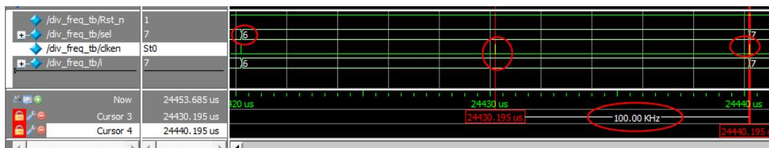
以下为 sel 为 15 时，输出的 clken 信号，可以看到 clken 一直为高电平，因此实际采样时候该信号一直有效，采样率就等于系统时钟 100MHz。
