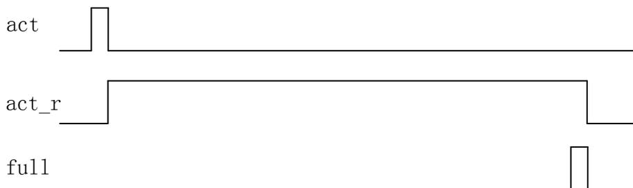
接下来我们就可以使用上述得到的采样触发信号和采样使能信号来控制采样存储过程了。所谓控制存储，一个关键操作就是产生 RAM 的写使能信号和写地址。写使能信号在使能采样状态下，满足触发条件开始有效，直到 RAM 写满，然后被清零。写地址则是在写使能有效的情况下，每个采样时钟累加一次。如下为采样控制部分代码：
